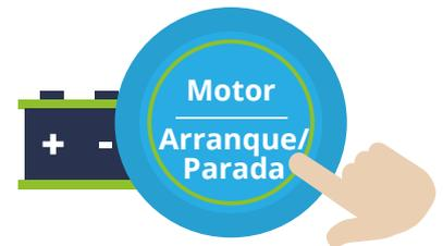
Las baterías de plomo son la tecnología clave de los motores de arranque-parada, que reducen en hasta un 10 % el consumo de combustible y las emisiones de CO<sub>2</sub> en vehículos con motores de combustión interna.<sup>8</sup>
